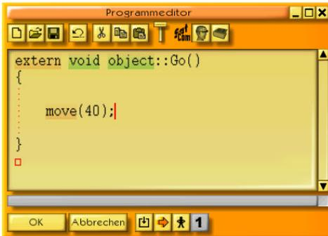
Das Ziel der Übung besteht darin, den Roboter gerade nach vorne zu fahren, so dass er auf dem blauen Kreuz 40 cm weiter vorne zum stehen kommt.
